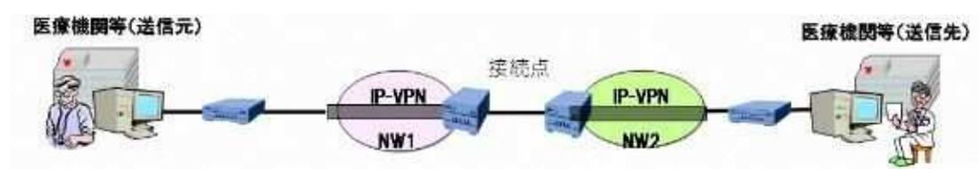
図③-b 中間で複数の閉域ネットワークが相互接続して接続されている場合
