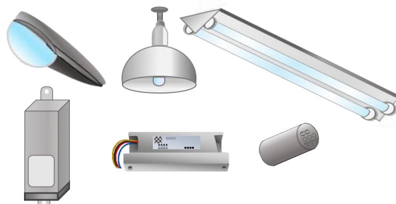
照明器具安定器・コンデンサー
